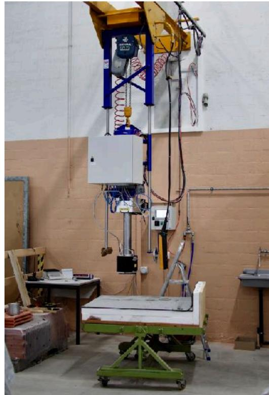
Bild 2: Hagelkanone der p+f Sursee über zu prüfenden Systemaufbau
