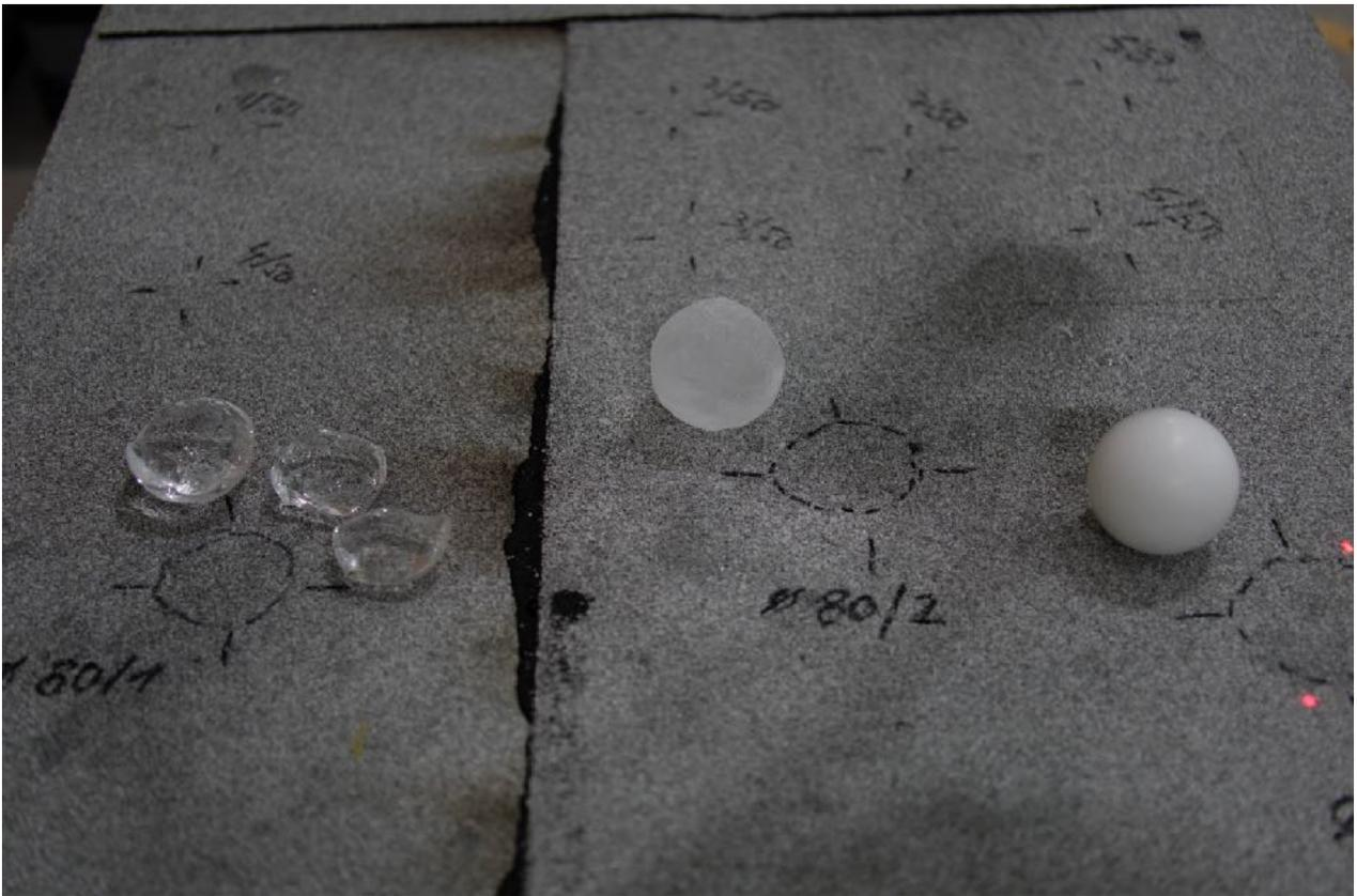
Bild 3: Zustand des zweilagigen Bitumendachs nach dem Extremtest:
